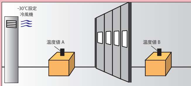
A. マグレン 耐寒断熱タイプ H2100 W2000 (1 枚 500 × 4 枚) 窓枠 260 × 300 ブラックフレーム
