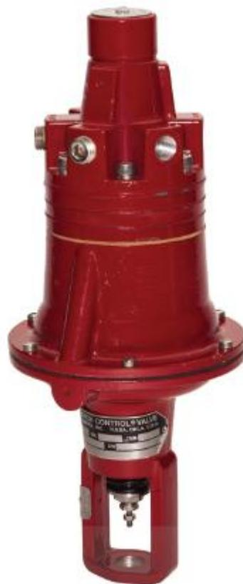
Badger社のアクチュエータは、3-15psi (20.7-103.4kPa) で製作しており、日本の一般的な仕様である20-100kPaで作動させると3.4kPaの差が生じます。この差のために、3-15psiで作動させたときに比べ、ストロークが僅かに短くなります。弁体の性能は変わりませんが、このストロークの関係でCv値がカタログ通りではない可能性があります。
