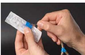
セプタムは気密性を確保しパッケージが破れないように保護するものです。パッケージやニードルによって適したセプタムが選択できます。
