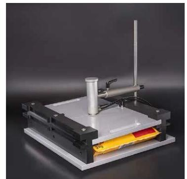
ASTM F2054 拘束用フィクスチャー：圧力がパッケージのシーリングに正しく作用するようにパッケージを拘束します。
