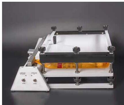
空気圧式パッケージクランプ(PPC 300 II)：ワンサイドオープンタイプのパッケージ、バッグ、パウチの破裂テストを実行できます。
