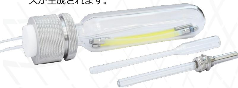
低濃度用パーミエーションチューブでは、化合物がテフロン®膜の片面に接触し、蒸気がゆっくりとテフロン®を通過します。この蒸気の「漏れ」はパーミエーションチューブの放出速度と呼ばれ、従来の方では制御できないほど低流量です。
