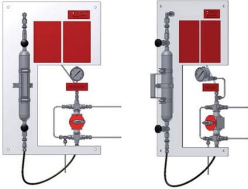
サンプルポイントのパージ機能により、コンタミネーションのない代表的なサンプルを最適に回収することができます。S32-G型サンプラーは、サンプルシリンダーでのサンプリングに加え、システムパージを提供し、サンプルシリンダーを取り外す前にクイックコネクカップリングを減圧することができます。
