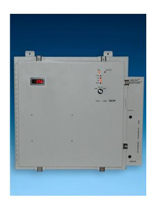
すべてのSpanPac<sup>™</sup>Iユニットは、NEMA 4仕様のキャビネットに収容されており、NECの動作の安全要件を満たすように設計されています。 クラス1、グループCまたはD、Div.II危険雰囲気。 これらのユニットは、Xパージオプションを追加することによって、Div.I危険雰囲気に適合させることもできます。 Zパージオプションは、NFPA 494のリビジョンに適合します。SpanPac Iキャビネットは、最大3つの透過オーブンを保持できます。
