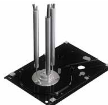
アプリケーション： ハードディスク ドライブの筐体測定
