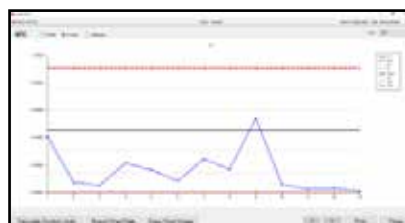
SPC機能追加 (ヒストグラム、上限リミット、下限リミット、Cpk、Ppkなどの計算が含まれています)
