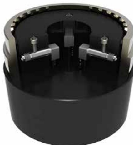
アプリケーション DZプローブによるリングの内径検査
