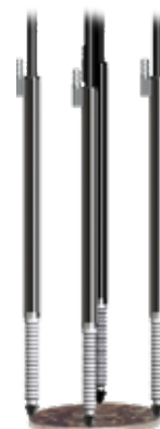
6 mm プローブでのコイン厚さ測定
