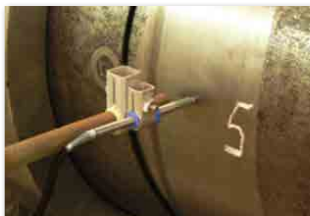
オイルタンクと水素タンクの変形やひずみをチェックするゲージプローブの拡大図
