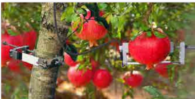
ソーラトロンセンサーを使用したザクロ石のデンドロメトリー
