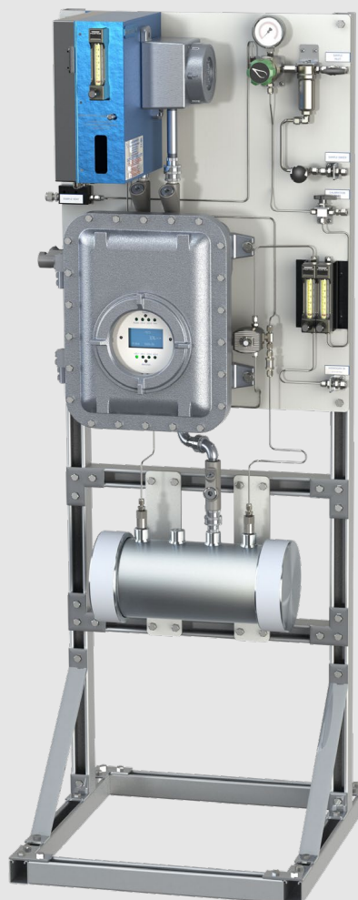
330S 型 H 2 S-全硫黄分析計 標準サンプリングシステム付き
