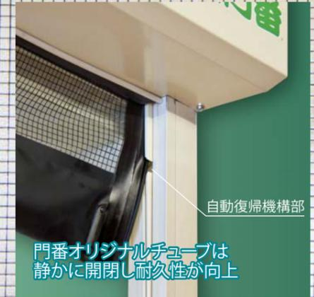
動作中にリフトや台車が衝突しても、一旦停止して低速上昇 (0.5m/秒) し自動的にレールへ復帰。万一の停電時も下端部を持ち上げるだけで女性でも簡単に通過できる安心の構造。
