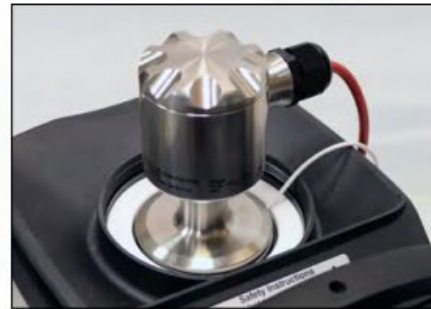
STS-102 A 035センサーとサニタリーセンサーをRTC-168キャリブレータのインサートに設置
