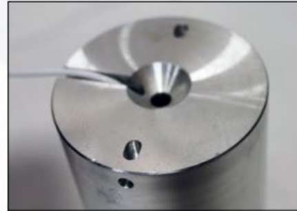
インサートに設置したSTS-102 A 035センサー
