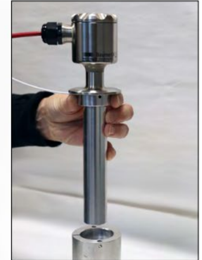
RTC-156インサートとRTC-168アダプターの組合せ
